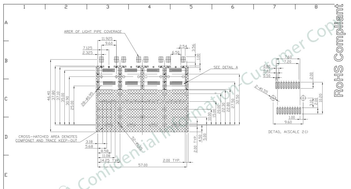
RECOMMENDED PCB LAYOUT (COMPONENT SIDE)
