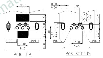
RECOMMENDED P.C.B LAYOUT Tolerance ±0.03mm
